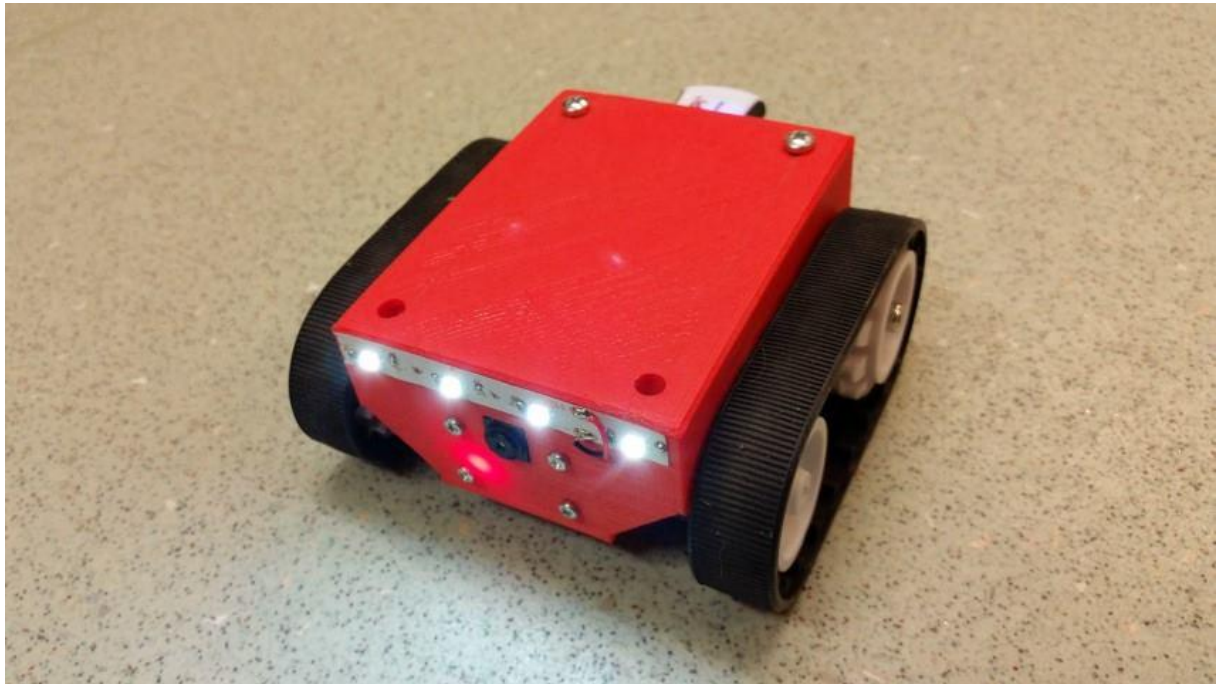
Figur 10. Robot med inbyggd Raspberry Pi
